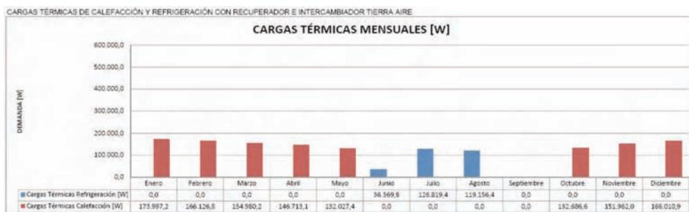
**Fig 22. Distribución mensual de la energía demandada por el edificio para calefacción y refrigeración en un periodo anual, una vez incorporados el pretratamiento del aire y el recuperador de calor. Reducción de 2/3 de la demanda. Fuente: eneres.**
